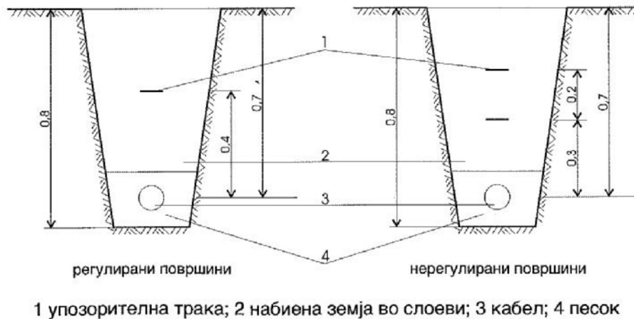
Слика 2-1. Полагање на НН кабел на рагулирани и нерегулирани површини
